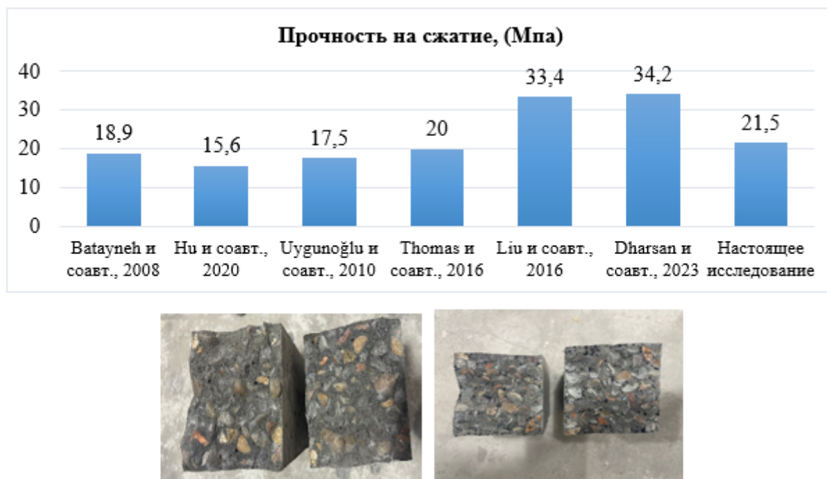
Рисунок 7. Поверхность сечения бетонного образца с добавлением резинового порошка
